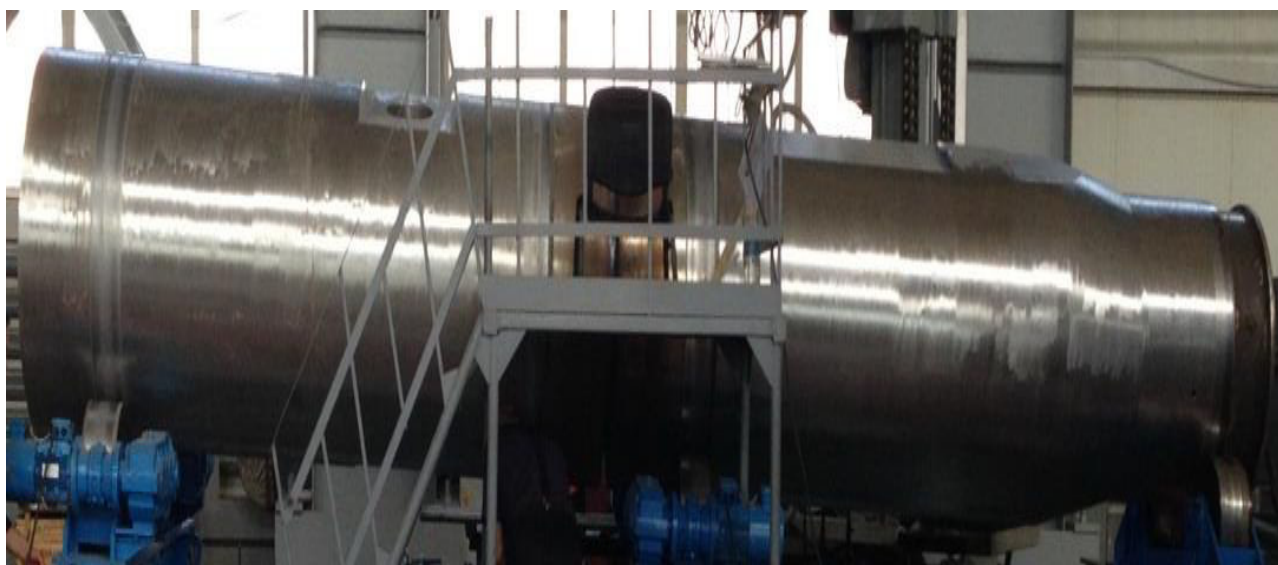
Рисунок 2.34-Цельнометаллический контейнер ВТУК -9М для перевозки и длительного хранения отработавшего ядерного топлива на Ленинградской АЭС.
