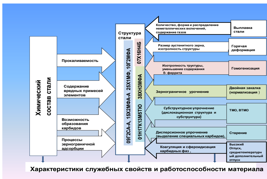
Рисунок 1.3. – Применение метода инжиниринга с целью управления процессами структурообразования и формирования свойств материалов контейнера с ОЯТ. (Ю.П. Солнцев, Т.И. Титова [13] и автор).
