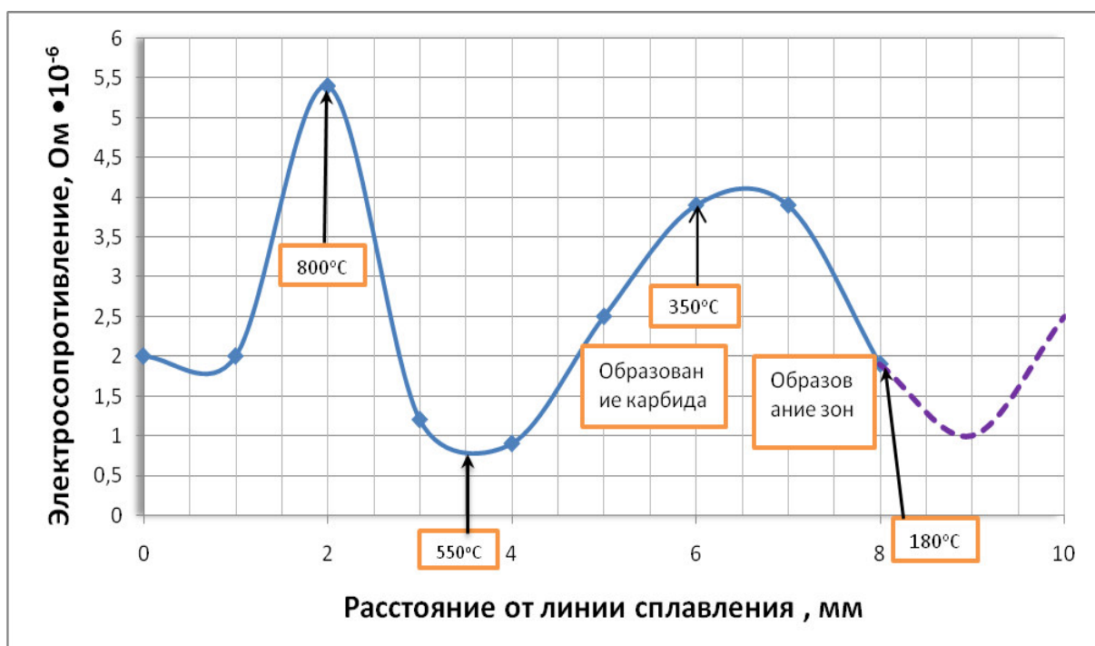
Рисунок 2.24 - Изменение электросопротивления ЗТВ сварного соединения из стали марки 09Г2СА-А со стороны поковки, (исходное состояние после сварки).
