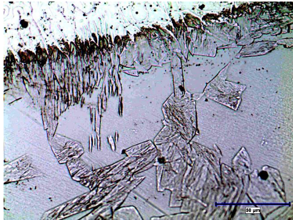
Рисунок 5.11 - Микроструктура сварного соединения стали 15X11МФ после отпуска при температуре 750°C.
