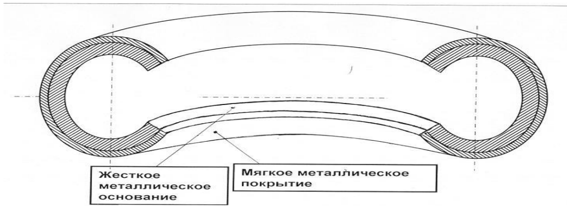
Рисунок 6.3– Конструкция торoidalного металлического уплотнения
