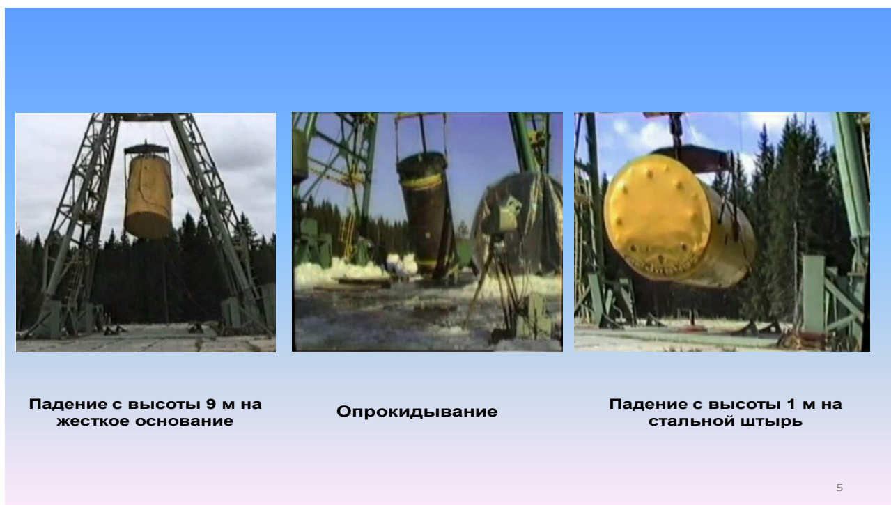
Рисунок 1.3- Виды экспериментальных стендовых испытаний контейнера
