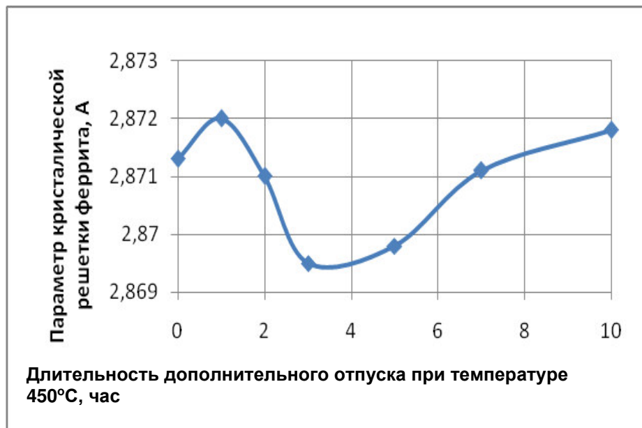
Рисунок 3.6 – Влияние длительности дополнительного отпуска при температуре 450°С на параметр кристаллической решетки феррита в стали марки 38ХНЗМФА.
