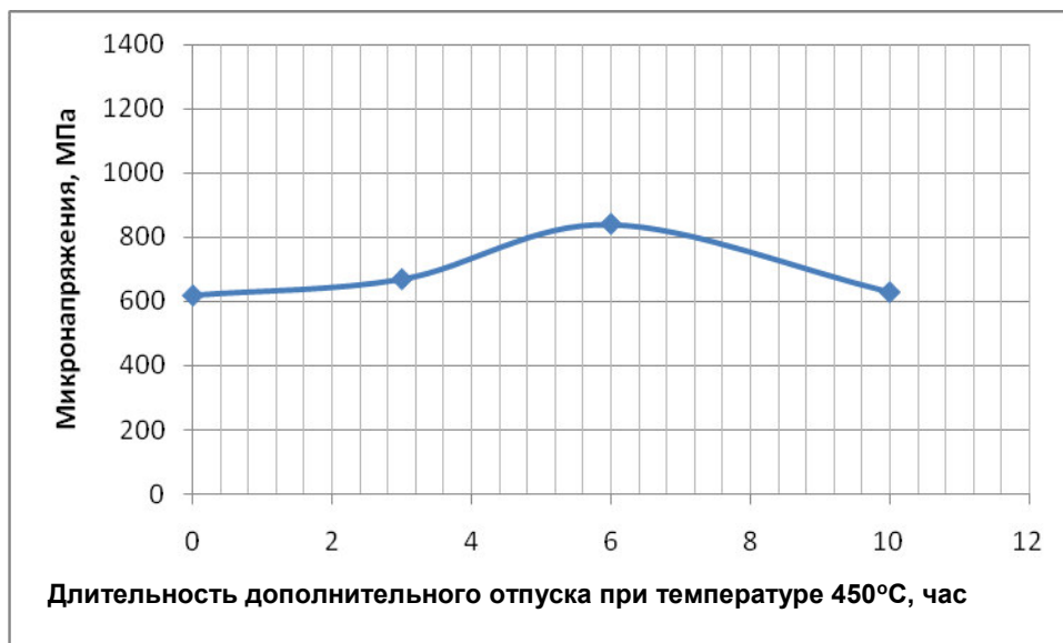
Рисунок 3.9 – Влияние длительности дополнительного отпуска на изменение микронапряжений решетки феррита в стали марки 15X2МФА.
